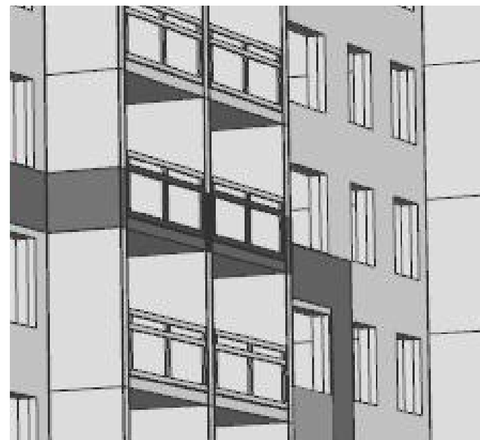
Detail řešení zábradlí lodžie
